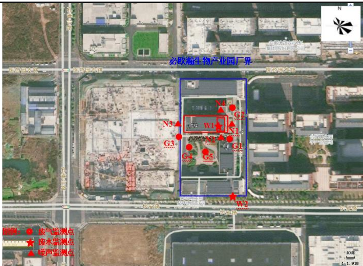
图 3-3 本项目废水、废气、厂界噪声监测点位示意图
